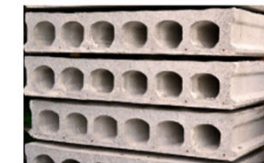
Beton huldæk i forskellige længder ovenpå metalstruktur
